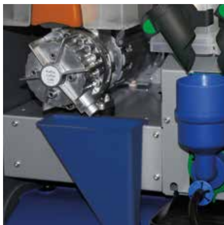
Direkte Weitergabe des frischen Mahlguts von der Mühle in den Brüher, über einen Trichter.
